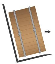
Nos trechos longos, durante a movimentação da bobina, devem ser usados dispositivos que evitem a quebra ou danificação da fita de amarração do conjunto. Quando a bobina for carregada por empilhadeiras, o eixo da bucha deve estar na mesma direção do deslocamento da máquina, sendo que os ganchos da empilhadeira devem ultrapassar a largura externa da bobina.
