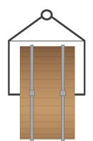
Nos pequenos trechos, o carregamento, descarregamento e transporte, especialmente em áreas de fabricação e armazenagem, podem ser feitos por equipamentos de levantamento ou suspensão, sendo obrigatório o uso de dispositivos que evitem danificação da bobina, ou mesmo sua exposição a esforços de compressão e movimentos bruscos. A bobina não pode ser rolada.
